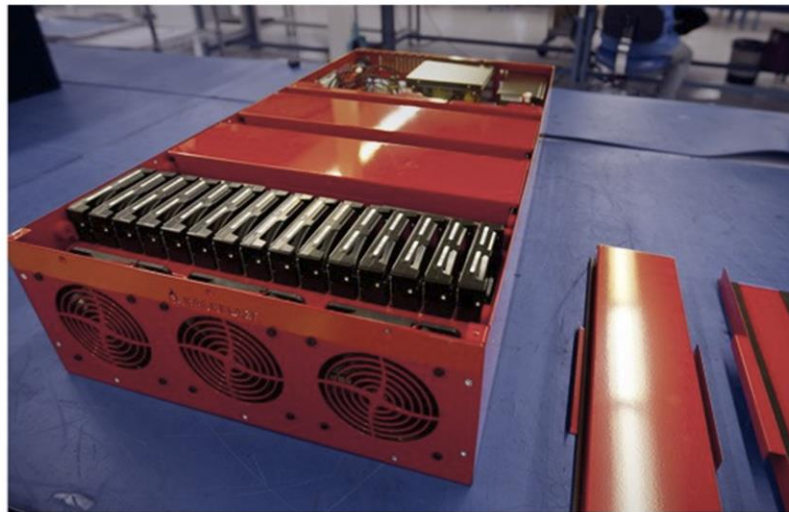
Backblaze Storage Pod 3.0 (Bild: Backblaze)
