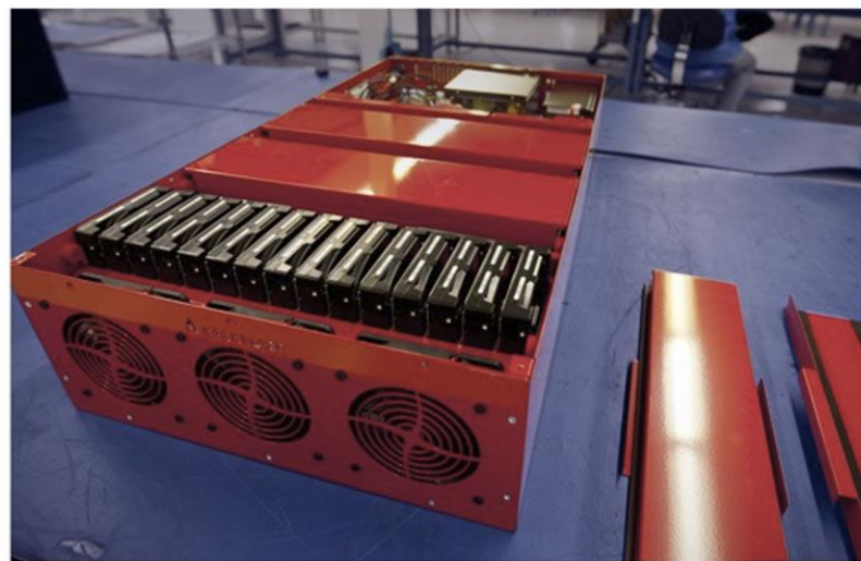
Backblaze Storage Pod 3.0 (Bild: Backblaze)
